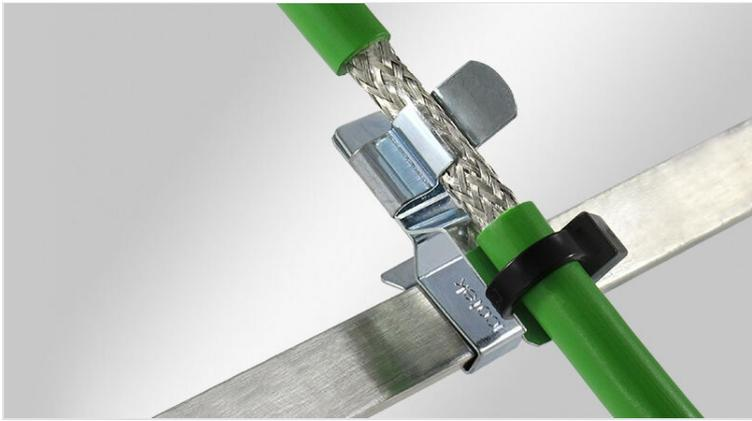
EMV Schirmklammern werden überall dort eingesetzt, wo der Schirm einzelner Leitungen mit dem Massepotenzial verbunden werden muss. Die Schirmklammern ermöglichen eine sichere und einfache Abschirmung von Leitungen.
